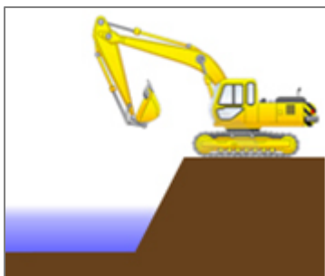
1.attēls. ekskavatora izvietojums, iegūstot derīgos izrakteņus zem gruntsūdens līmeņa.
