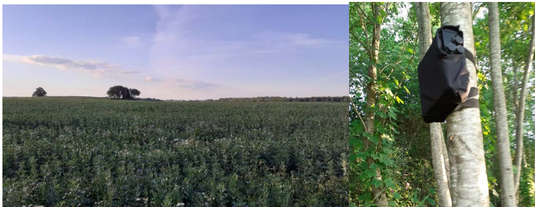
6. attēls Uzskaišu stacija D5 mežmalā. Detektors D-500X piestiprināts pie koka 2 m augstumā un vērsts uz klaju lauku
