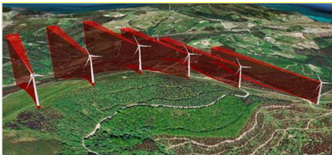
3.11.1. attēls. Aprēķinu piemērs par VES radītu zonu, kurā tiek bloķēts radara stars 150
