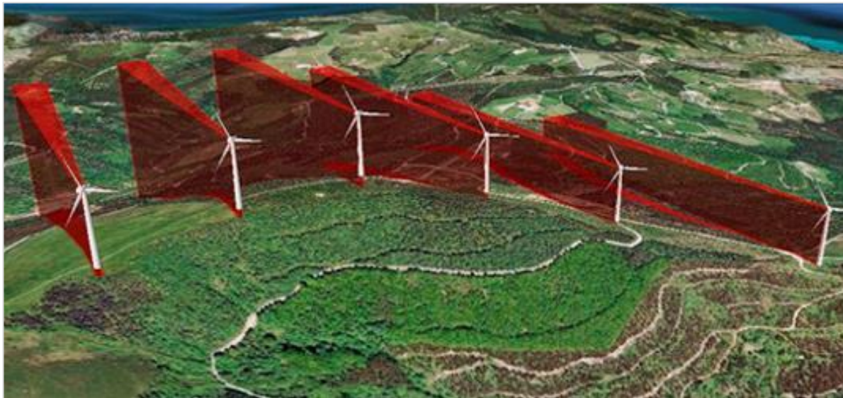
3.11.1.1. attēls. Aprēķinu piemērs par VES radītu zonu, kurā tiek bloķēts radara stars 169
