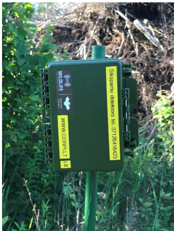
6. attēls. Viena no 15 periodisko novērojuma stacijām ar SM Mini Bat 2 detektoru. Ierīcei ir redzami marķējumi un pētījuma kontaktinformācija. Detektori tika uzstādīti uz mietiņiem.
