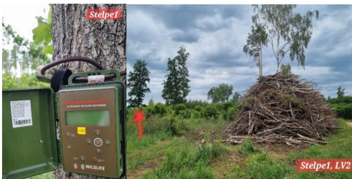
17. attēls. Nepārtrauktas novērojumu stacijas LV2 SM4BAT modeļa ultraskaņas detektors un ainava ap to.
