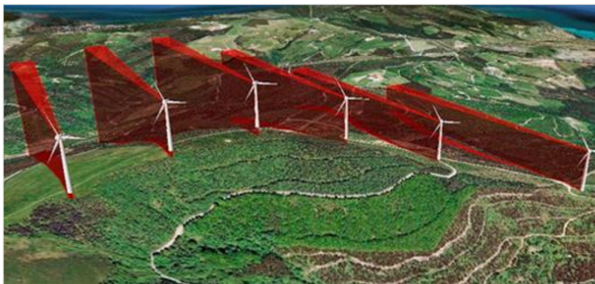
3.11.1.1. attēls. Aprēķinu piemērs par VES radītu zonu, kurā tiek bloķēts radara stars 167
