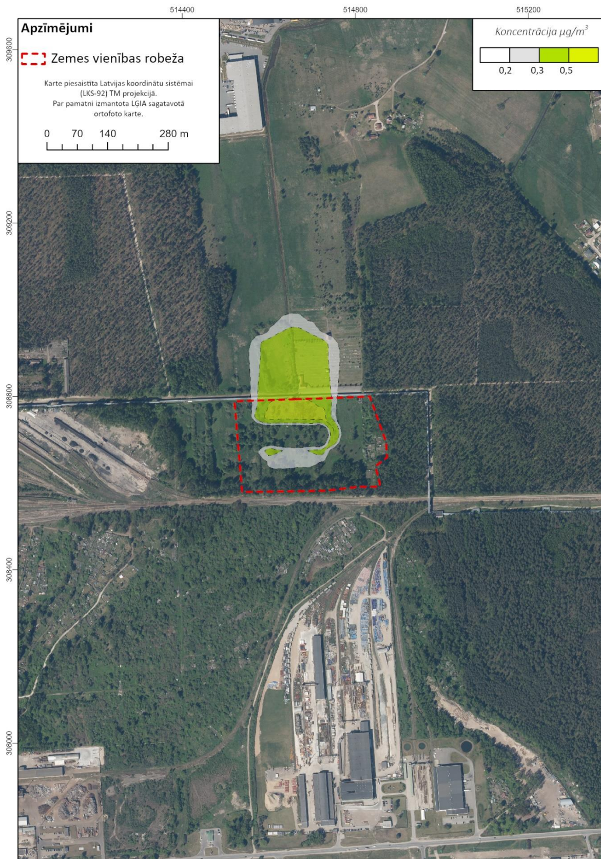
3.2.6. attēls. Daļiņu \text{PM}_{10} piesārņojuma izkliede – gada vidējās koncentrācijas, tikai paredzētās darbības gaisa piesārņojums
