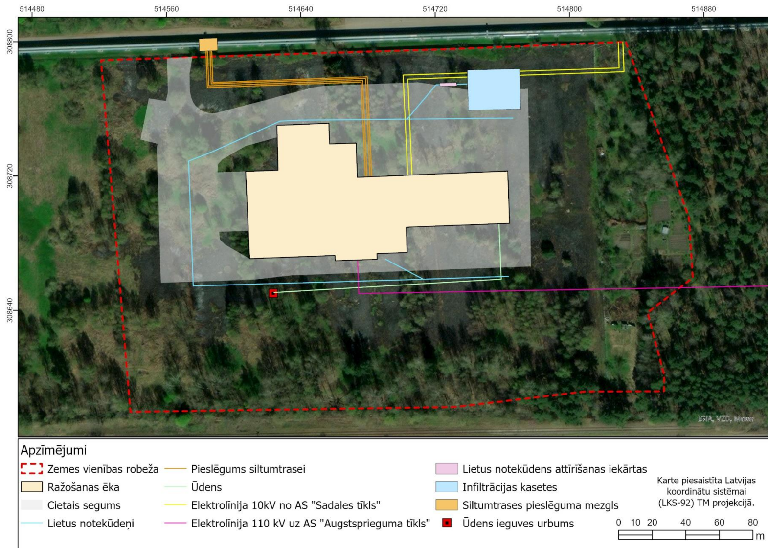
1.3.2. attēls. Inženierkomunikāciju izvietojums paredzētās darbības teritorijā
