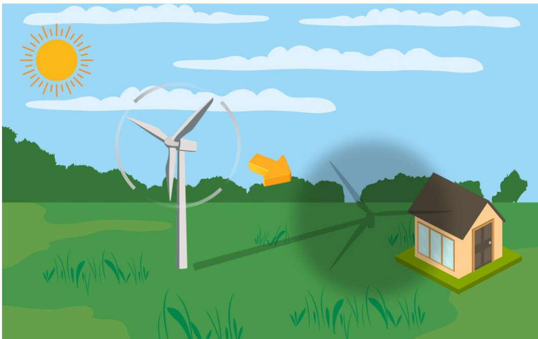
3.2.1. attēls. Mirgošanas efekta ietekmes shematisks attēlojums (avots: www.wkcgroup.com )
