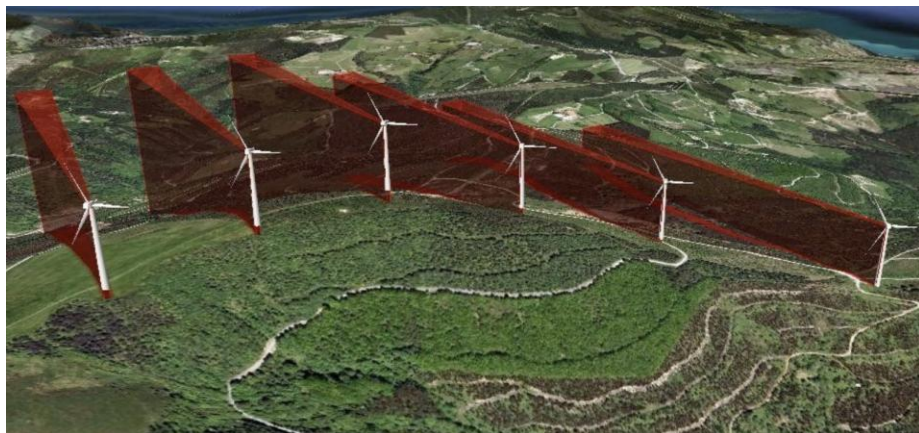
3.11.1. attēls. Aprēķinu piemērs par VES radītu zonu, kurā tiek bloķēts radara stars 301
